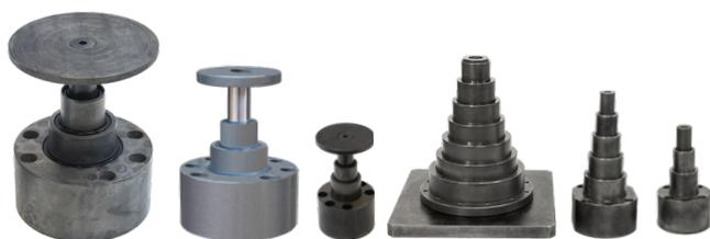
Questi cilindri idraulici telescopici sono compatti e in grado di lavorare con pressioni fino a 100 bar. Possono essere integrati nelle strutture delle macchine (le sedi possono essere ricavate direttamente nella struttura). Generalmente hanno corse che partono da 65 mm fino a 240 mm. Il loro utilizzo si rende necessario quando gli spazi sono limitati.
