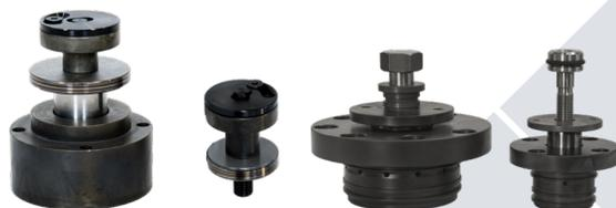
Questi cilindri idraulici a doppio effetto sono utilizzati per l'espulsione del blocchetto superiore negli stampi di pressatura dell'industria ceramica, vengono realizzati con diametri da 45 mm a 80 mm e corse da 13 mm a 60 mm. Sono realizzati con acciai ad alta resistenza e vengono inseriti nello stampo.
