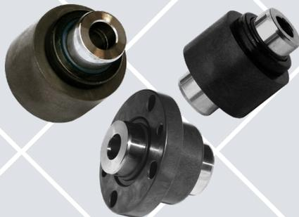
Boccole di guida montate nel blocchetto superiore degli stampi per ceramica. Queste boccole a compensazione termica consentono di guidare il movimento del blocchetto superiore anche in presenza di dilatazioni causate da aumento della temperatura.
